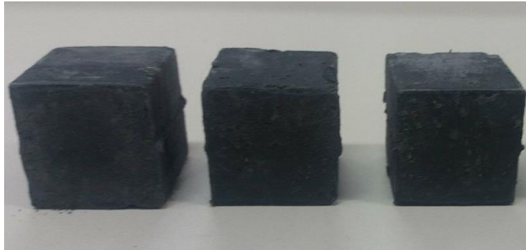
Figura 15 – Corpos de prova do CAT_A_0,97, para a realização do ensaio de compressão.
