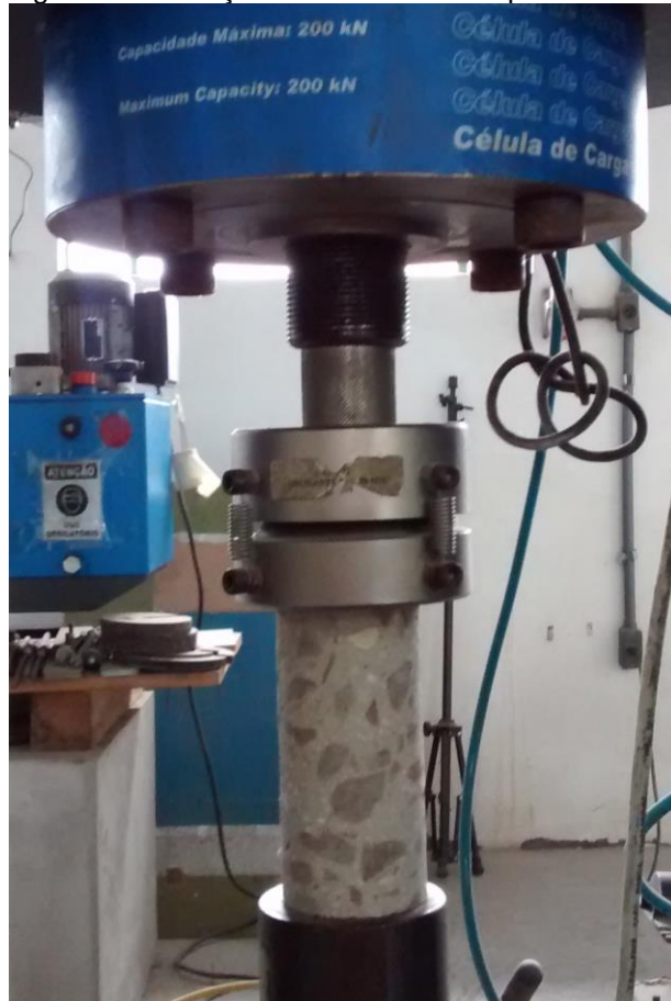
Figura 2 - Ilustração do ensaio de compressão axial
