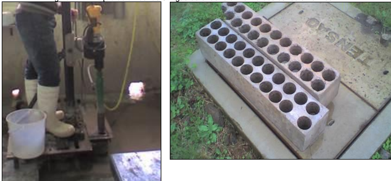
Figura 1 - Extração de amostras e Vigas de onde foram extraídos os testemunhos
