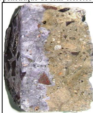
Figura 5: Profundidade da penetração de íons cloretos após ensaio acelerado.
